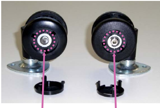
従来設計 支軸をカシメてあり 車輪を交換できない 分離設計 支軸をEリングで固定 車輪を交換できる
